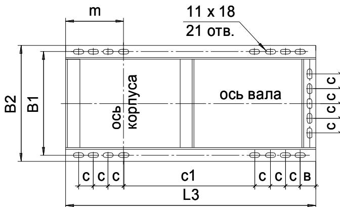
Расположение отверстий крепления вентиляторов 8
