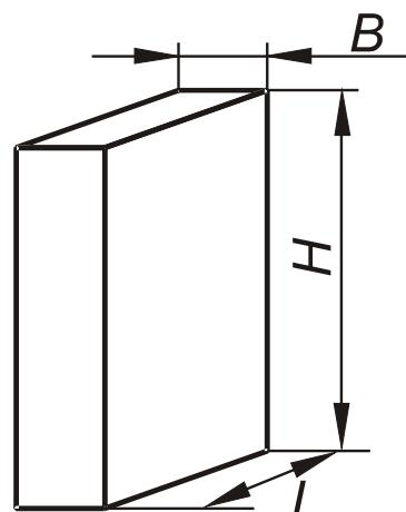
Входит в состав пластинчатого шумоглушителя ГП. Пластина шумоглушения состоит из корпуса, который выполняется из стального оцинкованного перфорированного листа. Между перфорированными листами уложен звукопоглощающий материал.
