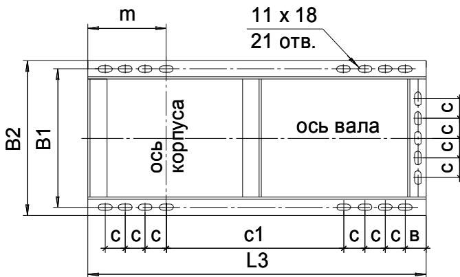
**Расположение отверстий крепления вентиляторов 10 .. 12,5**
