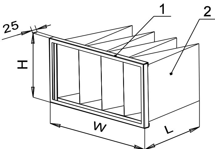
Обозначение фильтров при заказе: ФВК-W-H-L-Nk-Кл/25
