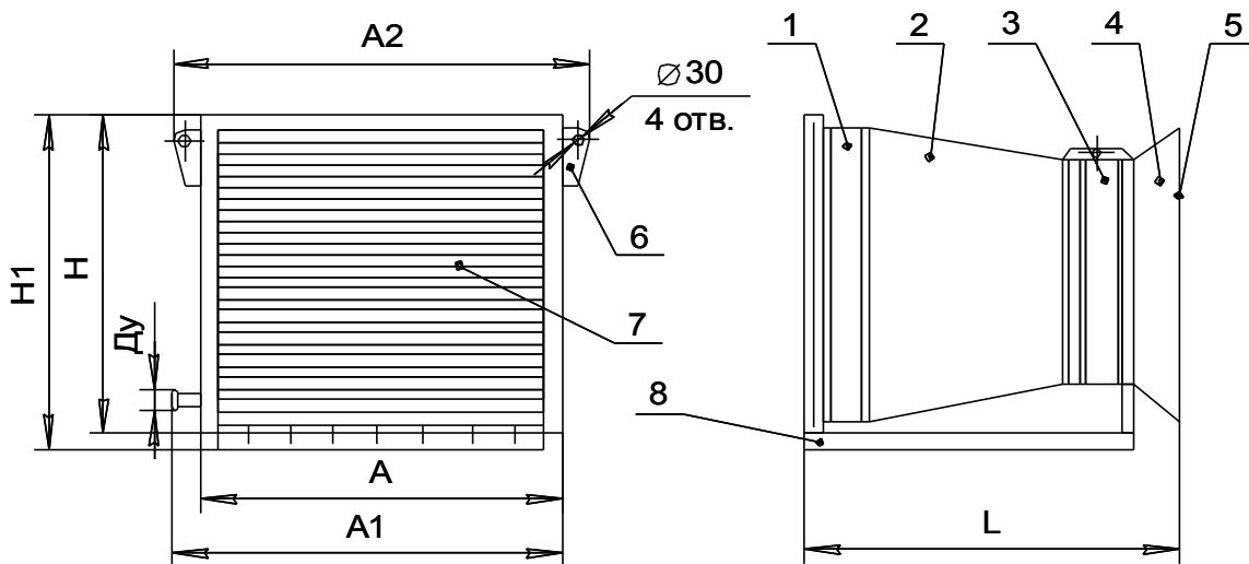
1 - калорифер; 2 - переход; 3 - вентилятор; 4 - диффузор; 5 - ограждение;
