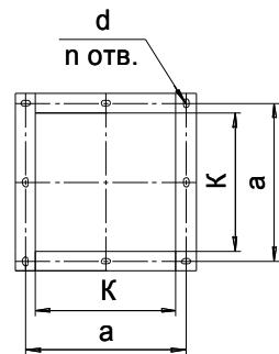
Расположение отверстий крепления вентиляторов 2 .. 6,3
