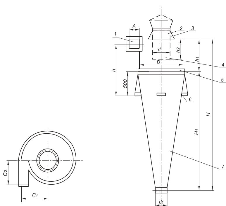
**Габаритные и присоединительные размеры циклона УЦ - 38**
