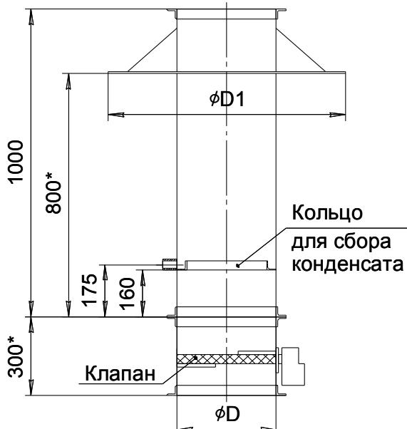
Примечание: а также изготавливаем узлы прохода УП 4.00
