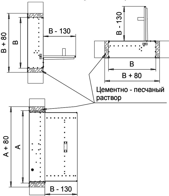
А – внутренний размер клапана, параллельный оси вращения заслонки.
