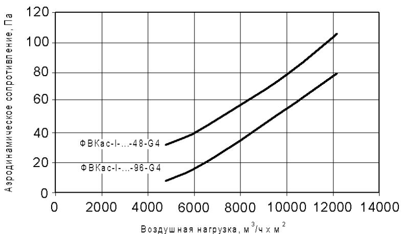
Расчет номинальной производительности для фильтров нестандартных размеров
