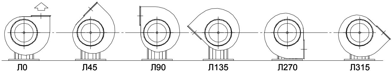
\*Положение корпуса на схеме отображено со стороны всасывания
