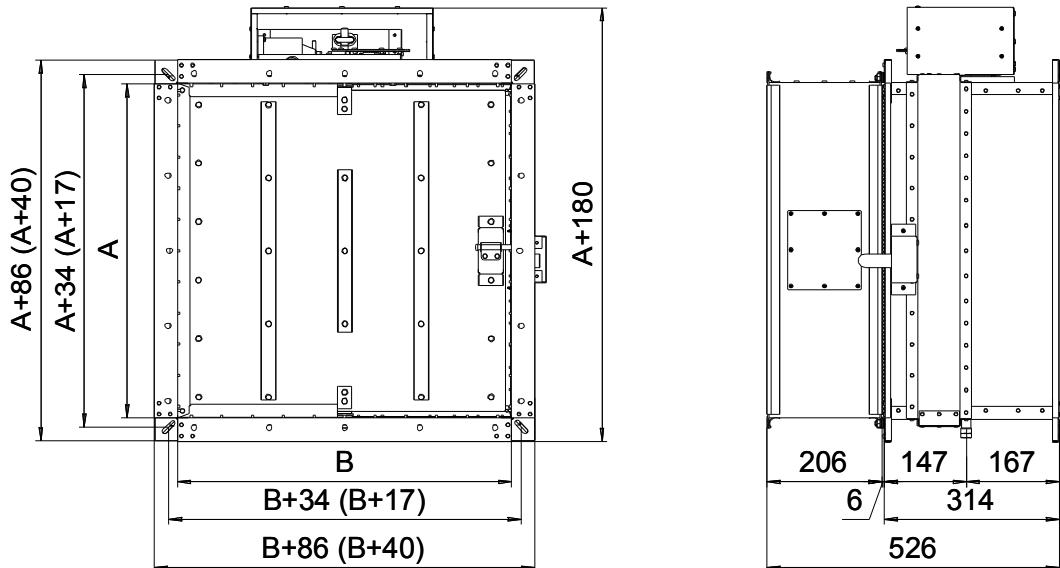
\* В скобках даны размеры патрубка клапана (секция №2).
