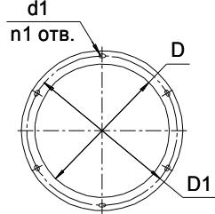
Выходной фланец вентиляторов
