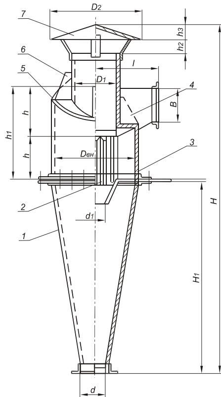
Циклоны типа Ц предназначены для механического улавливания древесных отходов. Циклоны устанавливаются только на нагнетание. Коэффициент очистки воздуха достигает 98 - 99%. Производительность от 500 до 23000 м<sup>3</sup>/ч. Циклоны комплектуются бункером.
