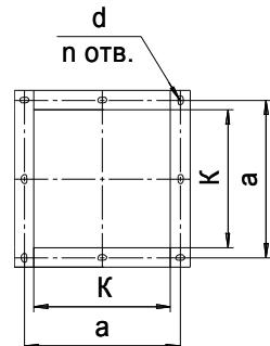
**Расположение отверстий крепления вентиляторов 2,5 .. 8**
