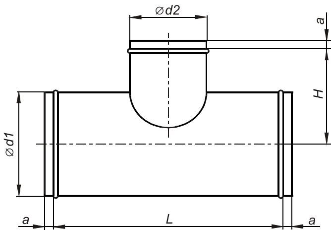
Условные обозначения для заказа: d1 - диаметр, мм d2 - диаметр, мм
