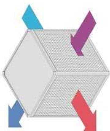
В теплообменнике два потока воздуха - приточный и вытяжной - проходят полностью разделенные, не перемешиваясь, при этом удаляемый воздух подогревает входящий из атмосферы воздух, так как имеет более высокую температуру.
