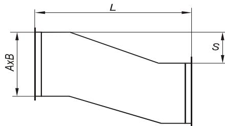
Рекомендуемые размеры S, L в зависимости от размеров воздуховода A x B
