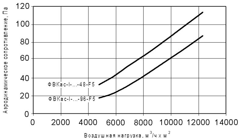
**Аэродинамическое сопротивление чистого фильтра ФВКас-I**
