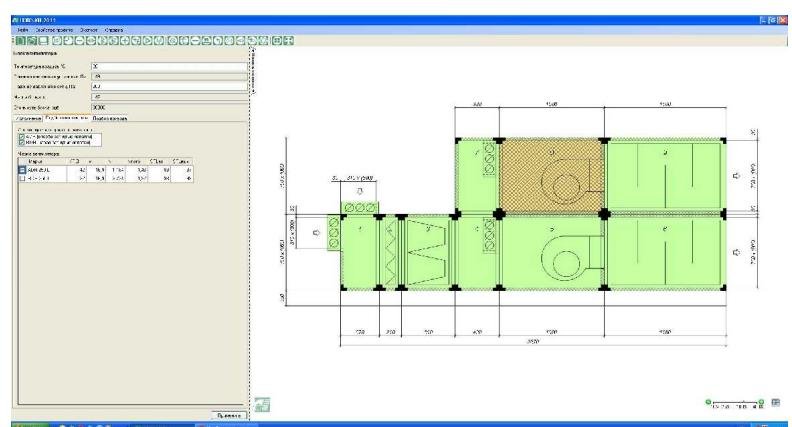
**Быстрое определение типоразмера установки в зависимости от расхода воздуха.**
