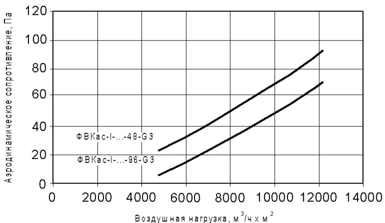
**Аэродинамическое сопротивление чистого фильтра ФВКас-I**
