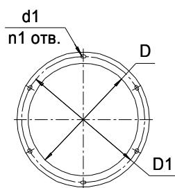
**Выходной фланец вентиляторов**
