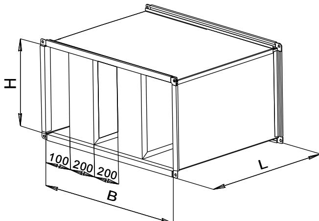
Глушитель представляет собой сборную секцию, состоящую из кожуха длиной 1000 мм или 1500 мм с размещением внутри него пластины, зафиксированными при помощи направляющих. Такая секция собирается и в собранном виде доставляется на место монтажа. Из этих секций набирается глушитель нужной длины.
