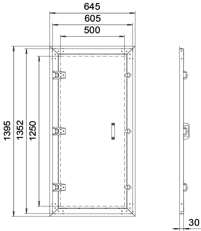
**ПАНЕЛИ РАВНОМЕРНОГО ВСАСЫВАНИЯ: 1П6, 1П9.**
